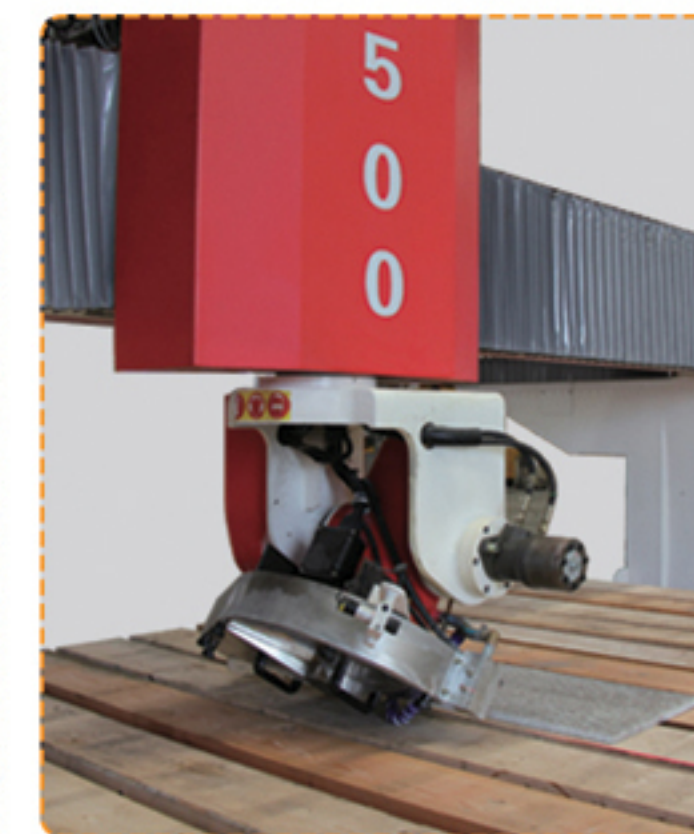
0^{\circ} – 90^{\circ} – 180^{\circ} – 270^{\circ} 全自动定位倒角切割;
