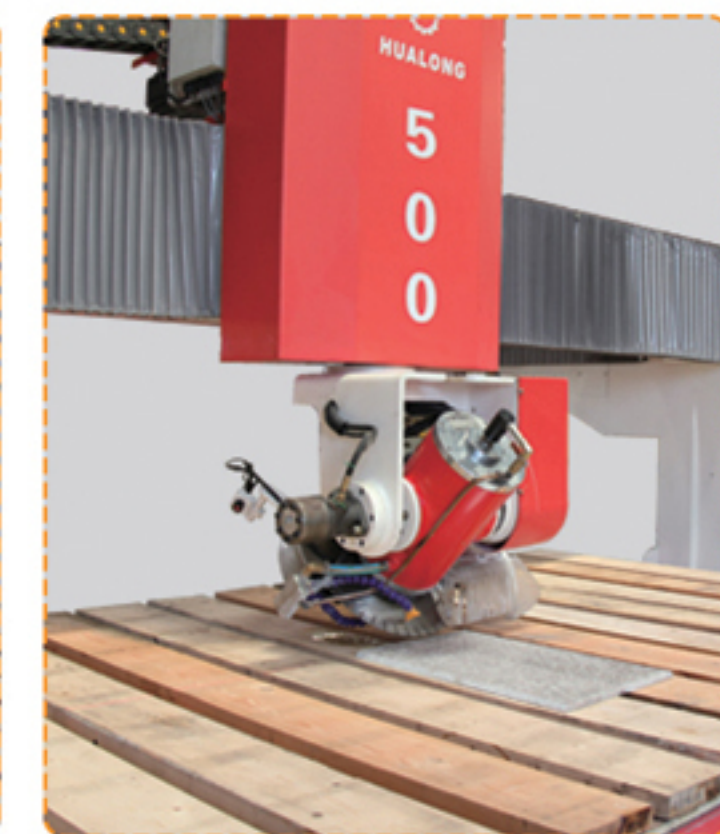
0^{\circ} – 90^{\circ} – 180^{\circ} – 270^{\circ} 全自动定位倒角切割;
